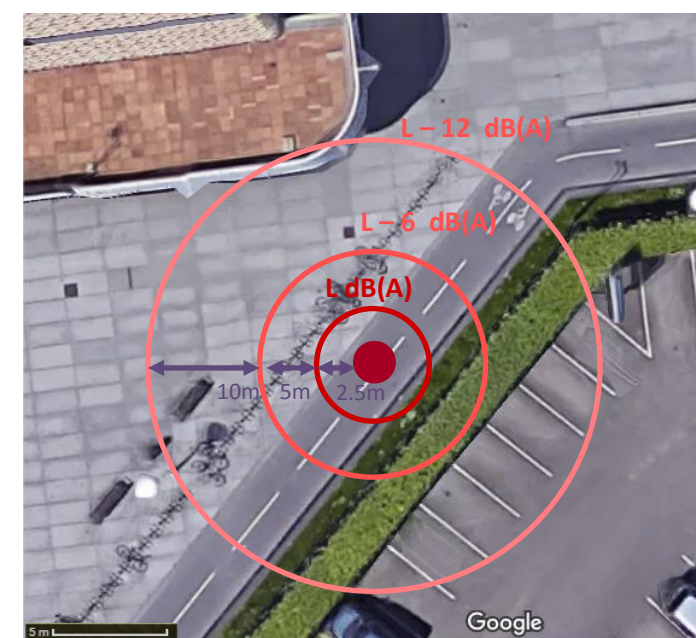
Figure 188 : Schéma de représentation de la décroissance du niveau sonore au droit d'une activité bruyante ponctuelle, exemple rue du Dr. Bouchut
