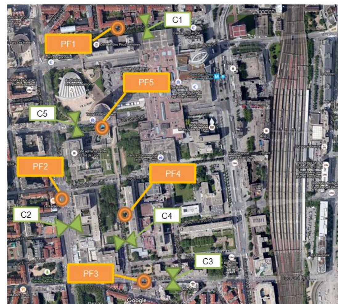
Figure 201 : Implantation des mesures de bruit/comptages réalisées en 2016
