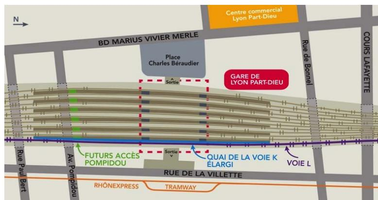
Pour disposer d'une voie de 400m à quai (permettant l'accueil de 2 TGV raccordés), il est nécessaire de réaliser une voie d'une longueur totale de 800m. Cette nouvelle voie utilisera le même quai que la voie K. Celui-ci sera élargi.
